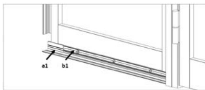
23. Zaag de afdekprofielen onder en boven **C1** en **C2** op maat en monteer deze vervolgens. Gebruik een slaghoutje om het profiel aan te drukken totdat deze geheel op zijn plek zit. Doe dit met twee man: een man dient tegendruk te geven terwijl de andere het afdekprofiel er op slaat.
