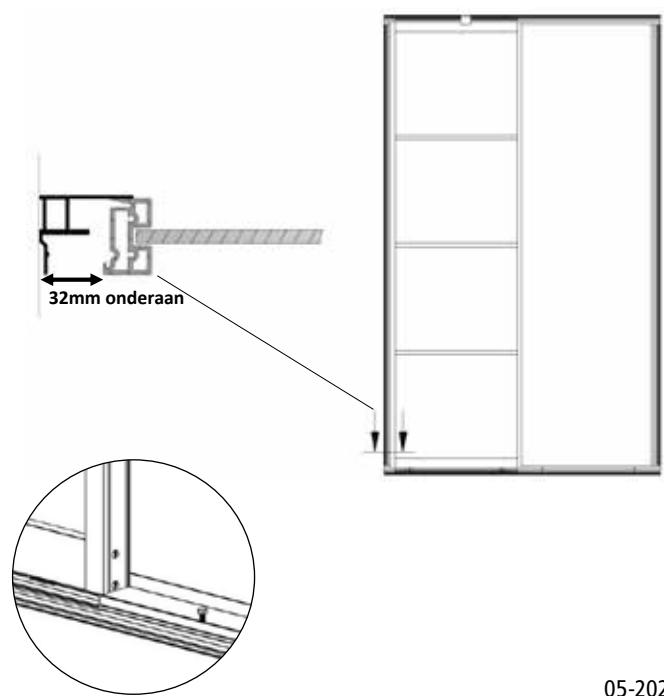
12. Meet de afstand H tussen het montageprofiel boven en het montageprofiel onder. Zaag het koppelprofiel **B** op de lengte **H**.
