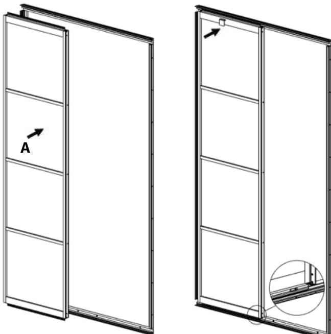
10. Vissez une vis hexagonale M5X30mm (**A2d**) dans l'écrou le plus proche du milieu du profil de montage (repère A). Ensuite, positionnez la tête de vis à une hauteur de **19 mm** (le dessus affleurant la marque sur le profil de montage). Positionnez les autres vis M5X30 à la même hauteur que la première (niveau à bulle) **ATTENTION**, en cas d'inclinaison ou de forte pente du sol, l'utilisation des vis M5 plus longues ou plus courtes, fournies, peut être requise.
