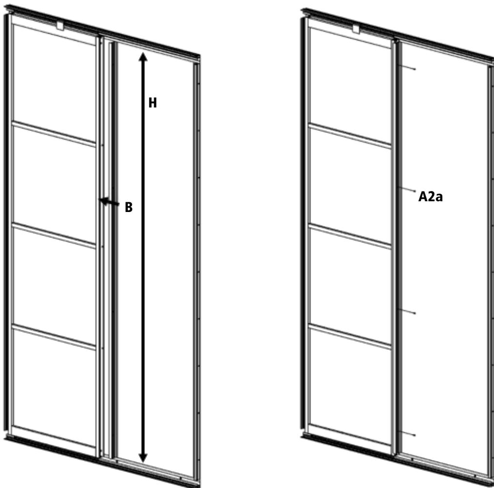
16. Schuif het volgende wandpaneel **A** in het koppelprofiel en op de bouten in het montageprofiel op de vloer.
