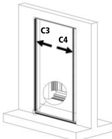
8. Relevez les dimensions H gauche et H droite entre le profil de montage haut et le profil de montage bas.
