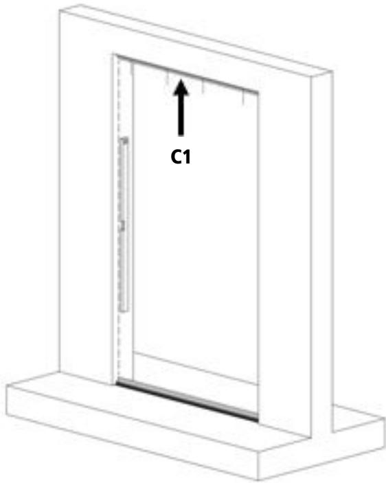
5. Sélectionnez le profil de montage **C1** et le profil de recouvrement prévus pour le haut, et sciez ces profils à la longueur du dessus B -1 mm. Conservez la chute du profil de recouvrement. Elle vous sera utile plus tard pour la fixation temporaire des panneaux de cloison.
