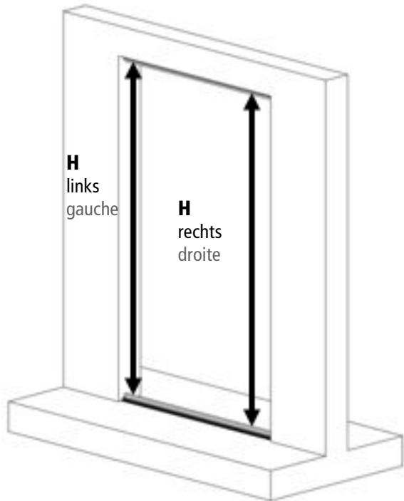
8. Meet links en rechts de afstand H tussen het montageprofiel boven en het montageprofiel onder.
